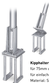
Bodenhalterung (LB075/LB100) für 75mm und 100mm Mastdurchmesser inkl. Exzenterring zur Mastjustierung, bei Nichtgebrauch durch Deckel verschließbar Material: Stahlguss/PP
