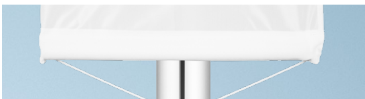
Unterkante mit Flutterbremse mit eingenähtem Kunststoffrohr und Kordel
