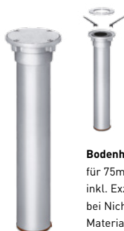
Bodenhalterung (BH075/BH100) für 75mm und 100mm Mastdurchmesser inkl. Kunststoff-Zentrierkeil zur Abfederung von Mastbewegungen Material: Aluminium/LD-PE
