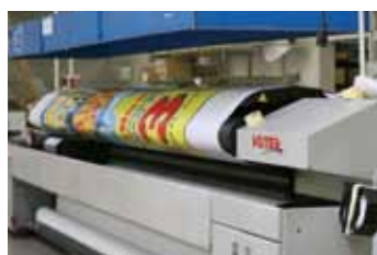
VUTEK-Maschinen drucken Breiten bis zu 500 cm.
